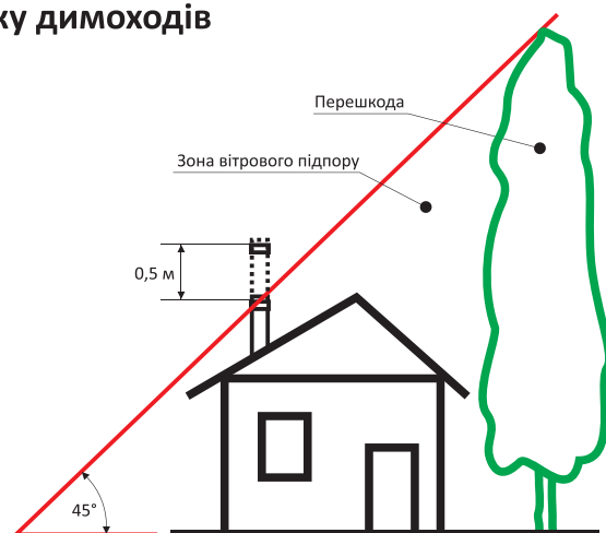
Нарощування димоходу при наявності перешкод біля будівлі
