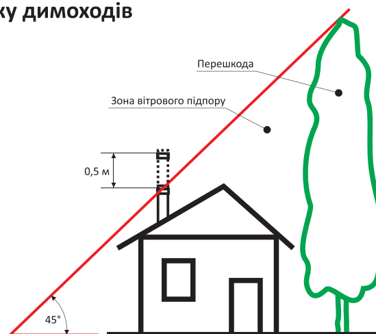
Нарощування димоходу при наявності перешкод біля будівлі
